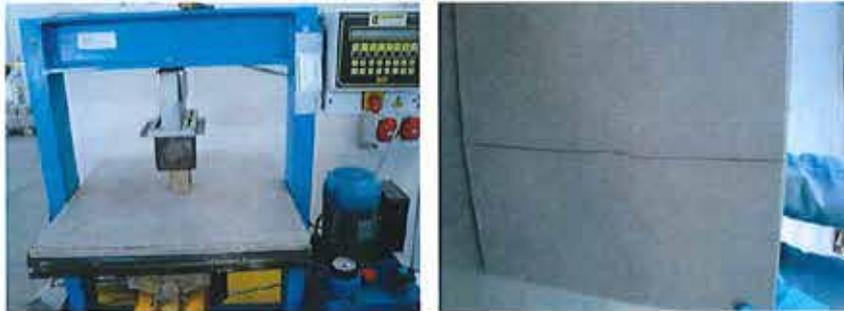
*Dettaglio di prova e di rottura del campione*
