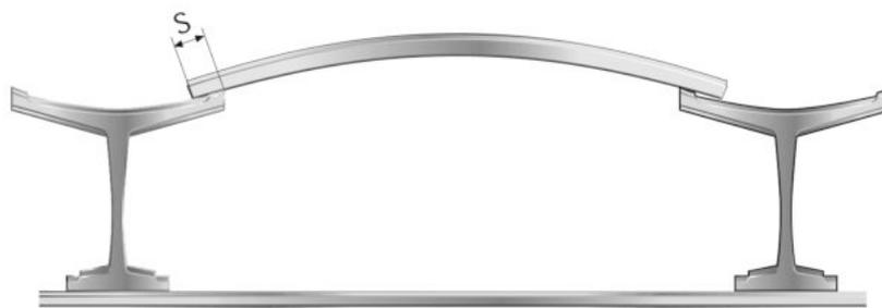
Occorre tener presente che le lastre curve in fibrocemento, grazie al loro profilo ed alle caratteristiche intrinseche del materiale, posseggono una elevata resistenza globale alla compressione e pertanto sono in grado di comportarsi come arco a spinta eliminata, purché il sistema di fissaggio adottato sia idoneo a contrastare tale spinta.
