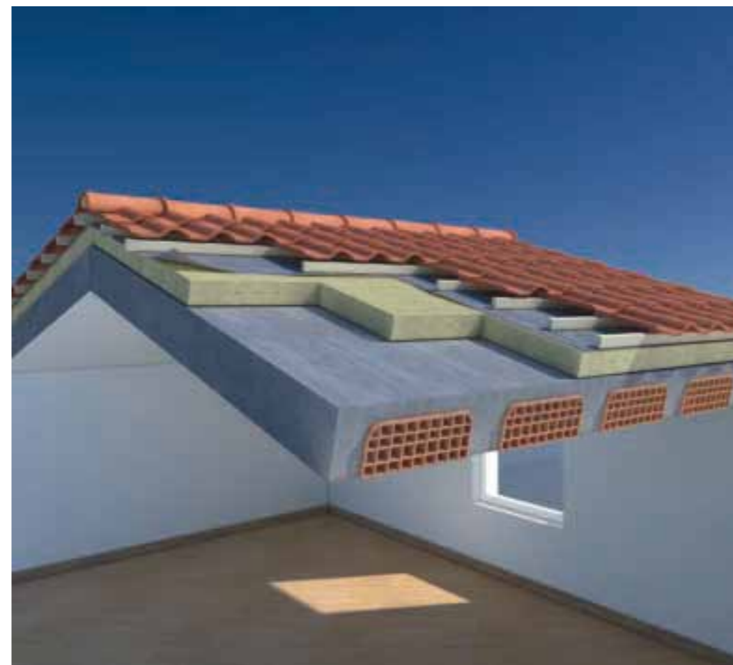
Copertura a falda formata da struttura in latero-cemento isolata con pannello in lana di roccia TERVOL DDP, ad alta densità, su cui poggia direttamente una listellatura a supporto tegole.
