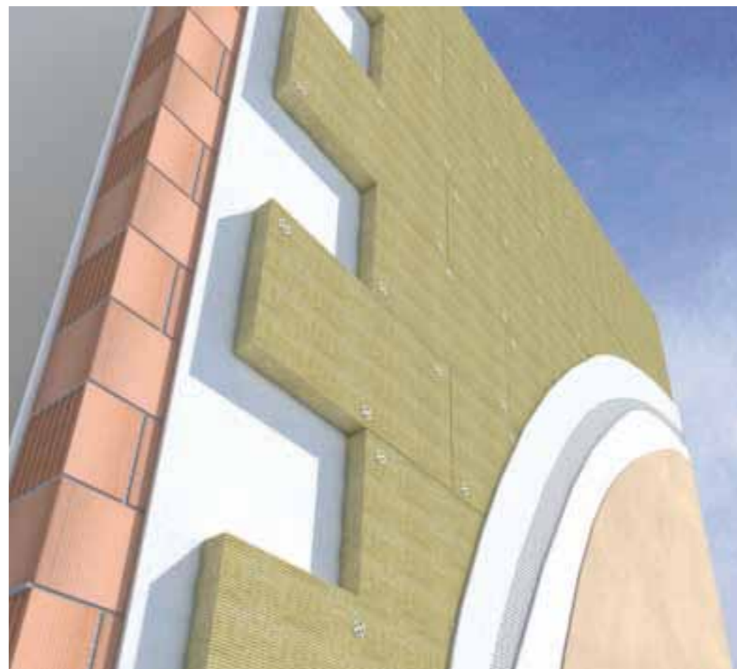
Parete perimetrale con struttura muraria in blocchi alleggeriti, isolata con pannello in lana di roccia TERVOL FP-PT, con sistema a cappotto.
