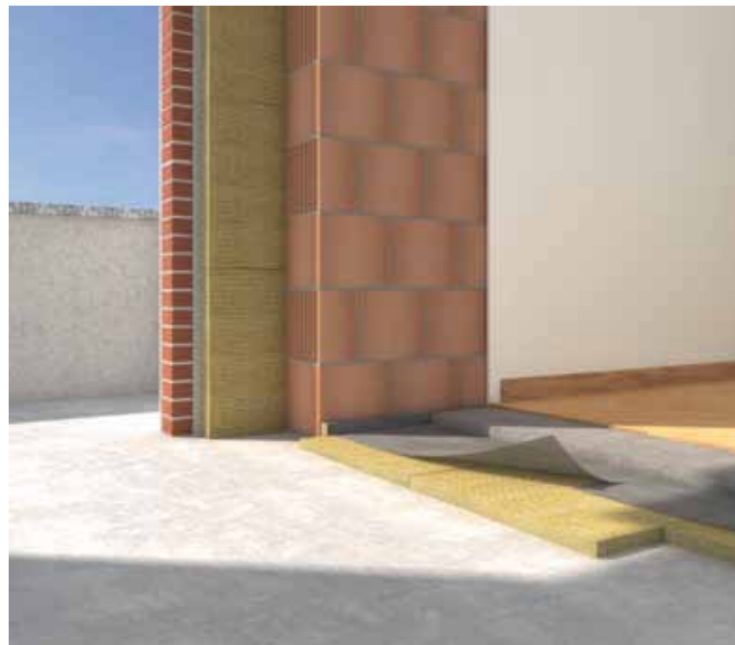
Solaio interpiano costituito da pavimento galleggiante isolato con pannello in lana di roccia TERVOL TP su struttura in latero-cemento.
