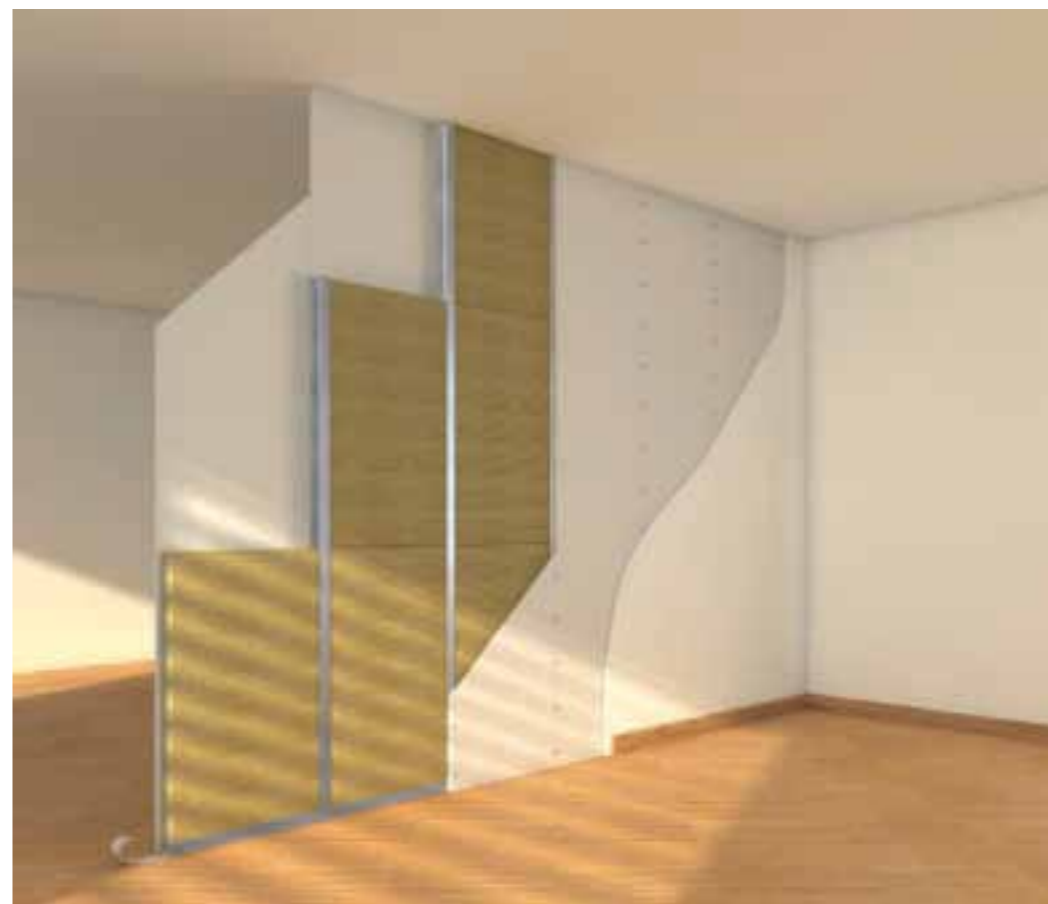
Parete divisoria a secco con lastre di gesso rivestito Knauf, a singola orditura metallica e singolo rivestimento, isolata in intercapedine con pannello in lana di roccia TERVOL DP4.
