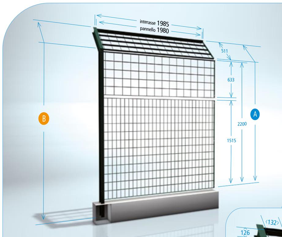
Le specchiature delle recinzioni **Athena 2** sono realizzate in grigliato maglia 66x126 e 126x132 con profili in piatto orizzontale 25x3 e tondini verticali. Nella parte superiore vi sono dei piatti di rinforzo mm. 60x4. Le specchiature sono realizzate da N. 3 pannelli per essere utilizzate in impianti sportivi.
