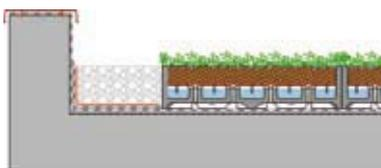
Il sistema nella versione "vegetata" non necessita di particolari interventi di manutenzione, tranne l'irrigazione (a saturazione) al momento dell'installazione e una manutenzione ordinaria con cadenza annuale (da eseguire preferibilmente in periodo primaverile) nel corso della quale oltre ai normali controlli di routine delle coperture si andrà a verificare:
