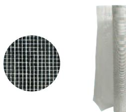
NET G64 è un'armatura di rinforzo in fibra di vetro, apprettata con un elemento antialcalino. Ha funzione di armatura di rinforzo in sistemi impermeabilizzanti con membrane liquide cementizie, su superfici regolari e caratterizzate da una corretta ripartizione dei giunti, per prevenire possibili fessurazioni generate da movimenti meccanici del supporto.
